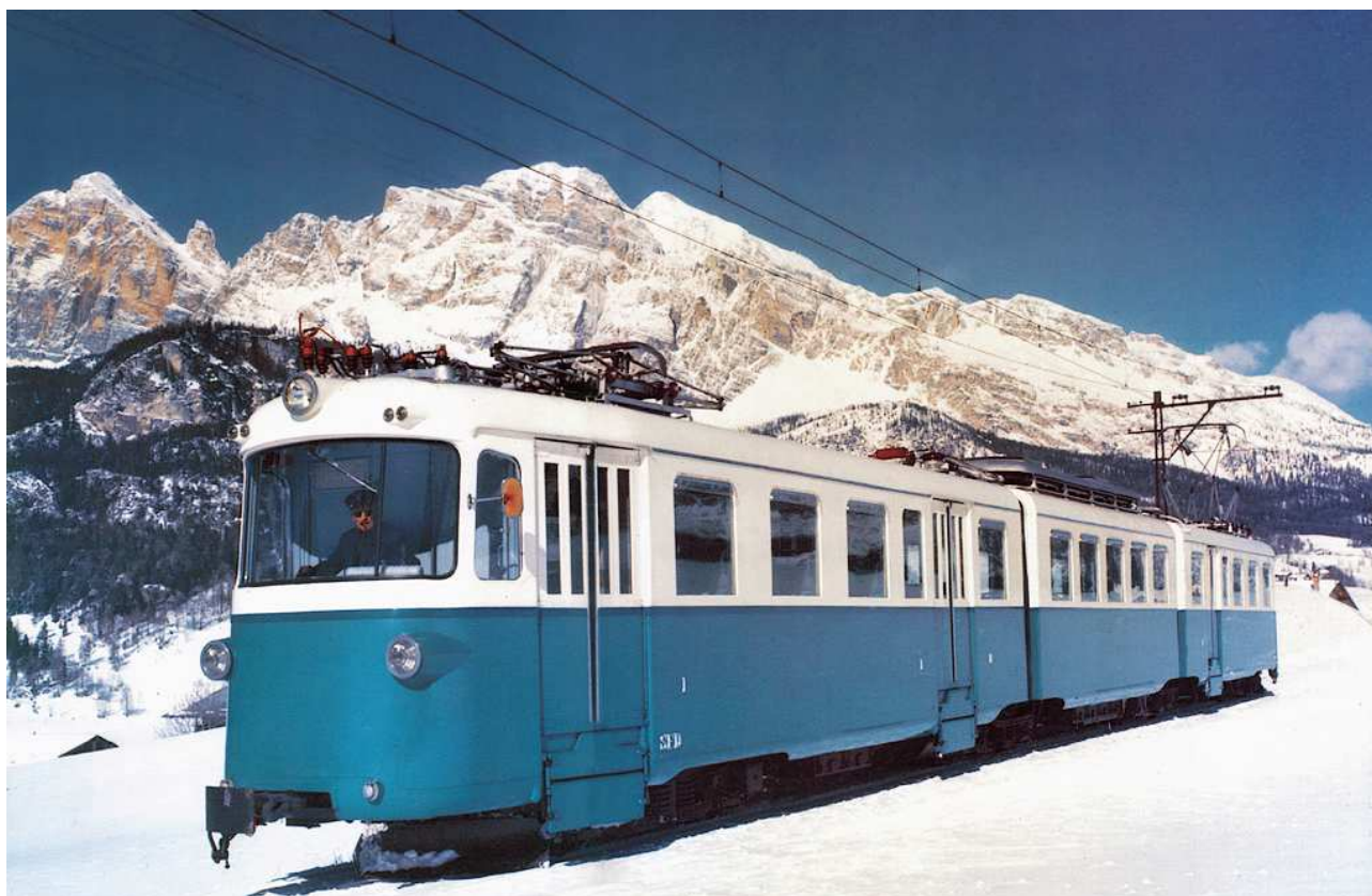
Elettrotreno in corsa prova sulla Calalzo - Dobbiaco nello splendido scenario delle Dolomiti, nel dicembre 1955. Tra le caratteristiche tecniche di questi veicoli, merita considerazione quella relativa al fatto che i due pantografi, tramite delle maniglie poste nelle cabine di guida, potevano essere isolati elettricamente, questo per poter trasformare, nelle fredde mattine d' inverno, il pantografo anteriore in un raschiaghiaccio (è risaputo che si ottiene il miglior risultato se il pantografo non prende corrente). La zona più critica era quella che fiancheggiava il lago di Landro, tra Cortina e Dobbiaco. Foto TIBB, dal libro "La Ferrovia delle Dolomiti" di Evaldo Gaspari
